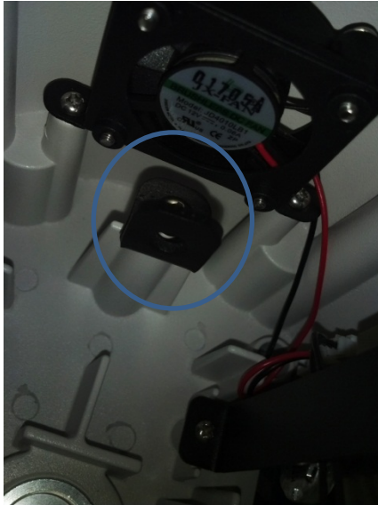
(d) Secure camera to lock
